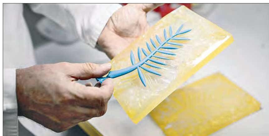
▲ La Palma de Oro es elaborada mediante la técnica tradicional de fundición a la cera perdida, en los talleres de alta joyería de Chopard, en Meyrin. Foto Afp
